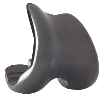
Linear와 Radial 밀링으로 제작된 인공 무릎 관절
